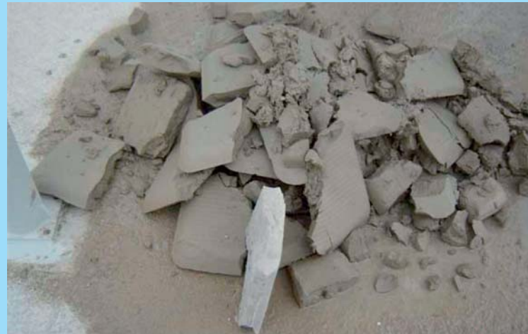
Gepresste Schlammkuchen für die Deponierung
